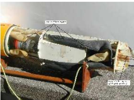
La presa d'acqua a mare è posta in basso a poppa. La pompa che provvede al carico/scarico acqua di zavorra è una Robbe cod. 1563. La pompa è del tipo ad ingranaggi, e per invertire in flusso è sufficiente invertire in senso di rotazione del motore.
